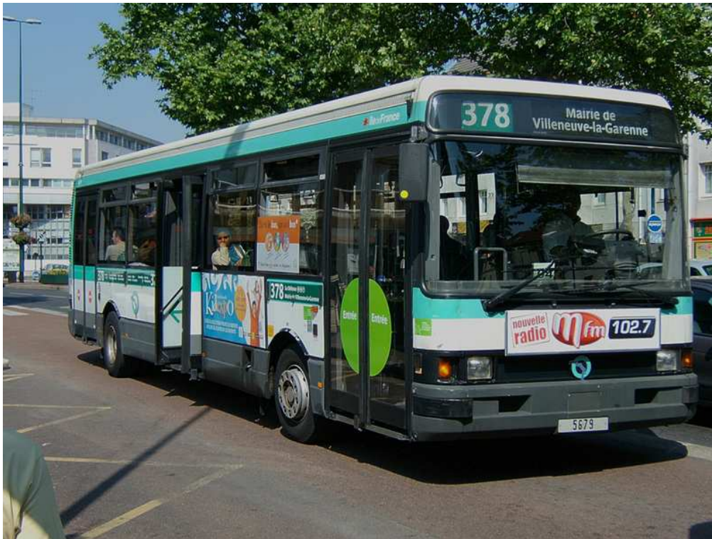
Colombes - Rue Gabriel Péri - 24 mai 2007 - Après l'expérience de 1988, les R312 sont rentrés dans le rang. La couleur de l'exploitant apparaît au-dessus et au-dessous des baies. Notez les 3 portes de cet autobus : une disposition malheureusement abandonnée en 1993 malgré la saturation de nombre de lignes. © transportparis.
