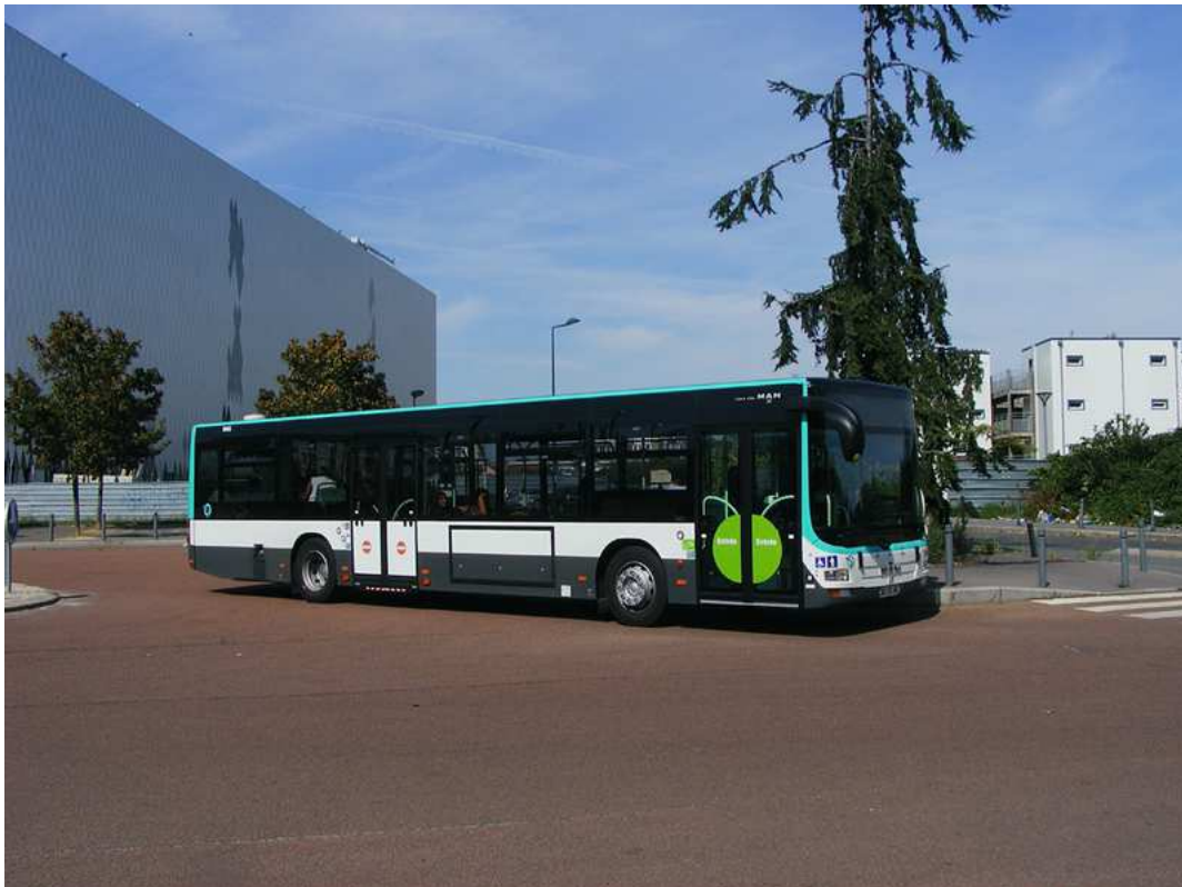
Saint Denis Université - 10 septembre 2011 - Depuis l'arrivée des derniers R312 à 3 portes en 1993, la RATP ne commande plus que des autobus standards à 2 portes. Cette disposition ne facilite pas le service, ni un confort satisfaisant puisque les voyageurs restent entassés entre les deux portes avant et milieu. Sur les Lion's City, la porte centrale a été reculée au maximum. © transportparis
