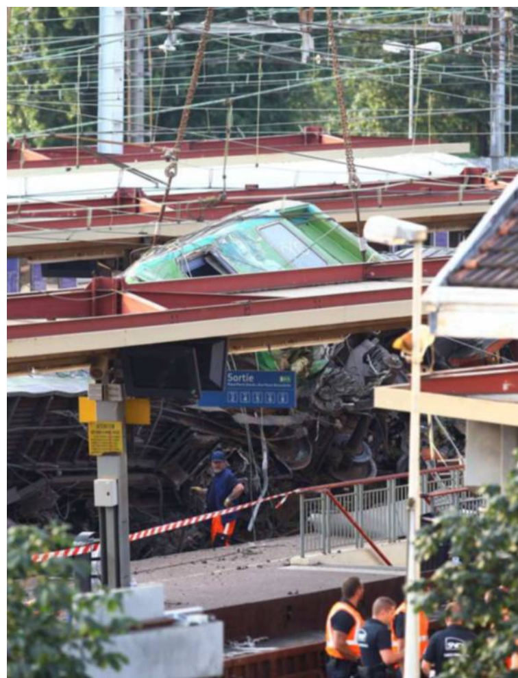
Brétigny-sur-Orge (Essonne), 12 juillet 2013. Sur la voie Paris-Limoges où a eu lieu l'accident qui a fait 7 morts et 32 blessés, 154 boulons ont été contrôlés. Un tiers d'entre eux étaient desserrés, cassés ou absents. (LP/Humberto de Oliveira.)
