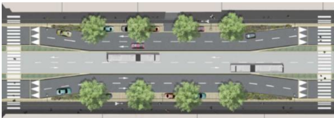
Principes d'aménagement – section courante type à 2x2 voies (source Egis / Ville et Paysage)
