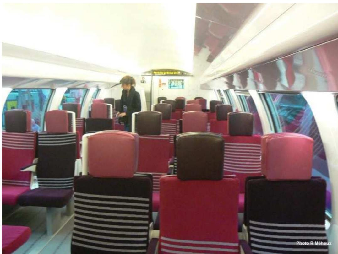
Le pas des sièges est de 1 m 750, ce qui est confortable. Chaque rangée est équipée de prise pour ordinateurs ou autre mobile.
