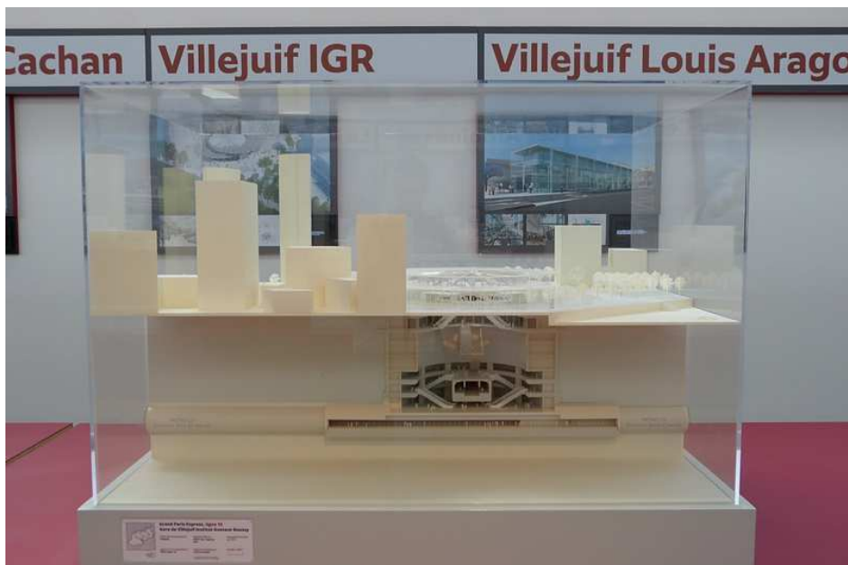
Autre symbole fort parmi les stations de la ligne 15, Villejuif Institut Gustave Roussy : elle accueillera la correspondance avec la ligne 14 prolongée depuis Olympiades. Etablie à proximité d'un important complexe hospitalier, elle aura elle aussi droit à une coupole, de forme moins complexe qu'à Noisy-Champs toutefois. Le puits de lumière assurera l'éclairage sur 4 des 5 niveaux de la station. © transportparis
