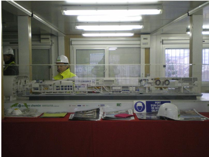
Il se compose de deux éléments, le bouclier et sa jupe et le train suiveur de 3 remorques. Le bouclier comprend la tête de taille et la chambre pressurisée ainsi que la vis d'Archimède de récupération des déblais.
