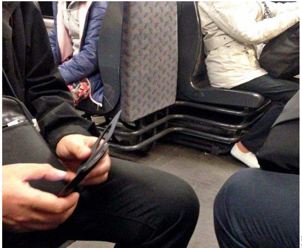
Les « paniers antibombes », installées sous les sièges dans les RER A et B à la suite de l'attentat de 1995.
