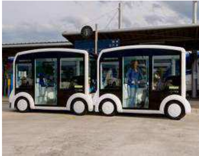
100 % électrique et silencieuse, la petite navette Cristal dispose d'une autonomie de 120 km sans recharge. Photo Joël
