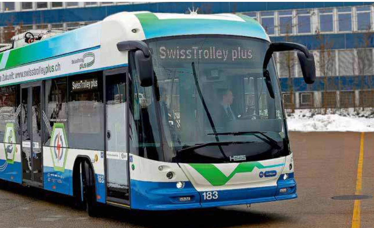
«Swiss Trolley plus». La Ville de Zurich teste depuis le mois de mars des trolleybus à batterie électrique.
