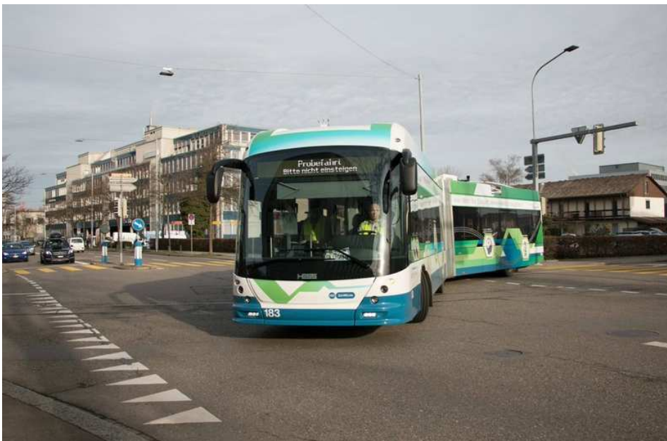
C'est peut-être lui l'avenir ? Le Swisstroy Plus de Hess présente la particularité de disposer de batteries de grande capacité pour circuler en autonomie et ainsi limiter le besoin en infrastructures, tout en maximisant le périmètre d'utilisation de ces véhicules. L'expérimentation en cours porte sur des lignes entièrement dotées de bifilaires et une ligne équipée sur le tiers de sa longueur, ce qui semble suffisant pour recharger les batteries. Le tout avec une technique de captage basique. (cliché VBZ)
