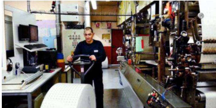
Usine Paragon Identification. D'énormes machines, parmi « les plus grosses du monde », permettent d'imprimer les tickets sur des bobines de plusieurs kilomètres de long.
