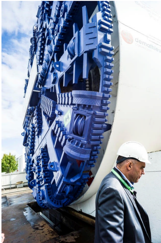
Herrenknecht, fabricant de tunnelier. Présentation d'un des tunneliers vendu pour le Grand Paris Express. Tête de forage du tunnelier. (Schwanau, Allemagne, 18 septembre 2017)
